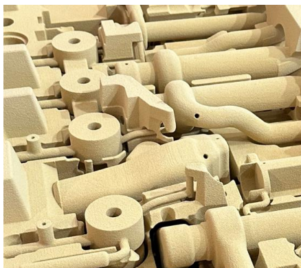
Noyaux de moule en sable fabriqués avec une imprimante 3D
